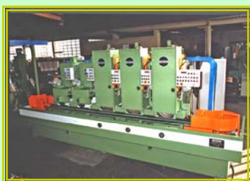
Шлифовальный / полировальный станок с 3 ленточно-шлифовальными + 2 полировальными станциями
